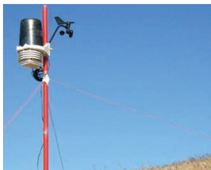
Рис. 2.1. Пример АМС, предназначенных для разных исследовательских задач: а) система BWS200 фирмы CAMPBELL Scientific; б) система AWS-2700 фирмы AANDERRAA Data Instruments; в) система Vantage Pro фирмы DAVIS Instruments; г) система WXT520 фирмы VAISALA
