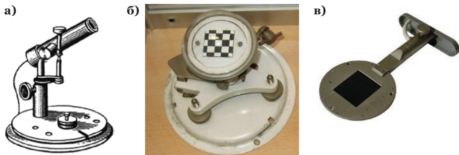
Рис. 1.8. Основные актинометрические приборы: а) актинометр, б) пиранометр, в) балансомер
