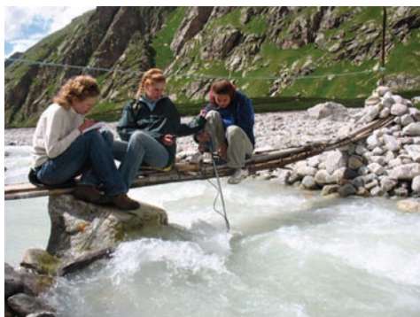
Рис. 1.14. Измерение расхода воды методом ионного паводка: а) гидрологический пост на горной реке; б) кондуктометр Christian Berner AB «WTW LF 95»
