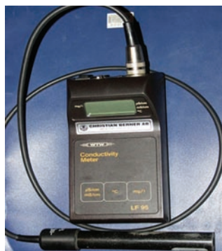
Рис. 1.14. Измерение расхода воды методом ионного паводка: а) гидрологический пост на горной реке; б) кондуктометр Christian Berner AB «WTW LF 95»
