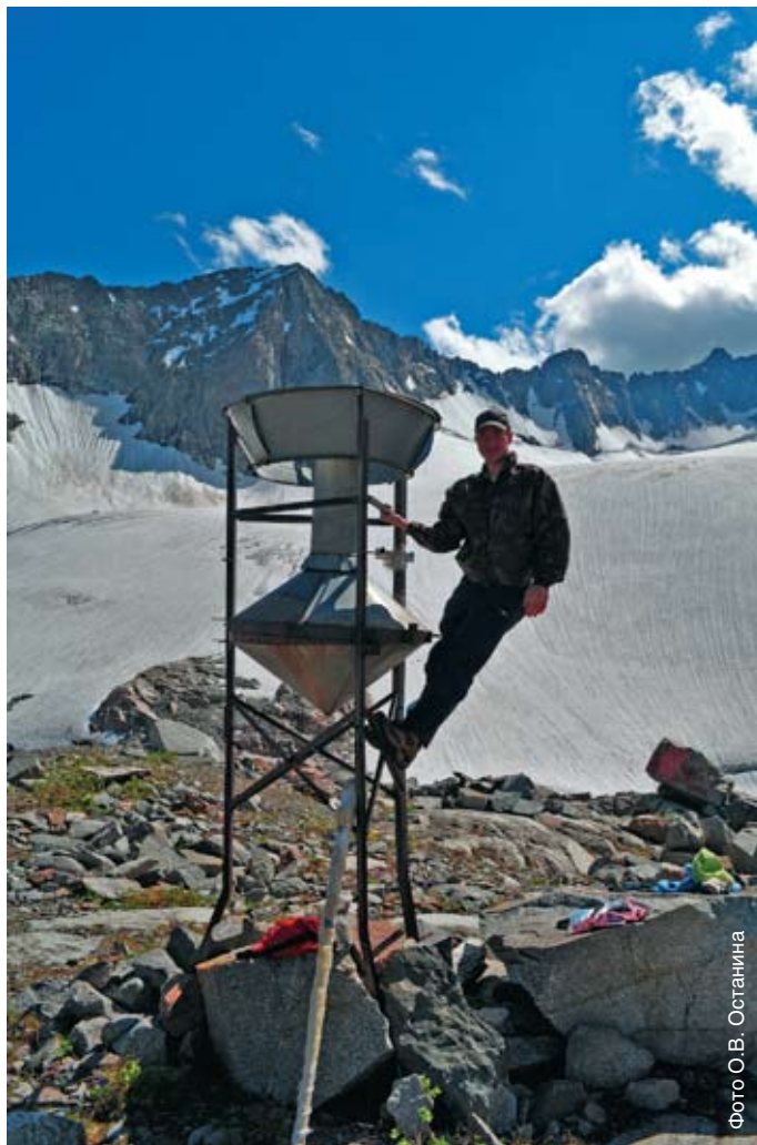
Рис. 2. Общий вид суммарного осадкомера (М – 70), установленного под языком ледника Томич
