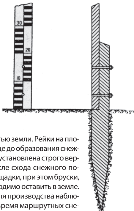
Рис. 3. Установка постоянной снегомерной рейки
